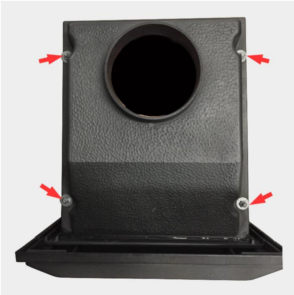
Abb. 1: Die 4 Schrauben, mit denen der Dom befestigt ist, lösen (s. rote Pfeile). Den Dom abnehmen, Reste des Kesselkits von Dom und dem Heizgerät gründlich entfernen. Dom zur Seite legen.
